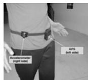
Figura 12. Porte de acelerómetro y GPS. Adaptado de "Objective Measurement of the Mode of Commuting to School Using GPS: A Pilot Study", por Villa-González, E., Rosado-López, S., Barranco-Ruiz, Y., Herrador-Colmenero, M., Cadenas-Sánchez, C., Santos, M. P., & Chillón, P. (2019). Sustainability, 11(19), 5395.
