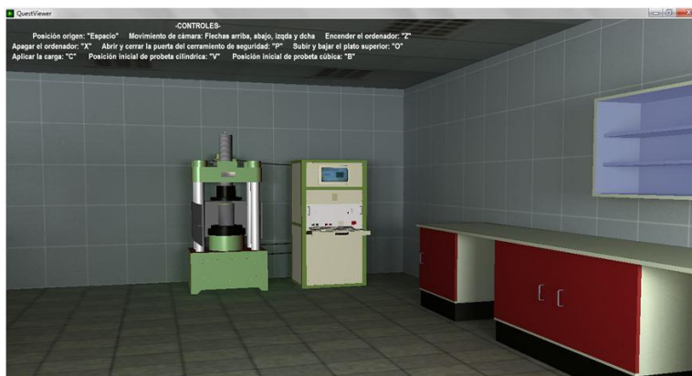
Figura 1. PVI simulando cómo funciona una máquina de ensayos de compresión de hormigón (Vergara et al, 2014a).
