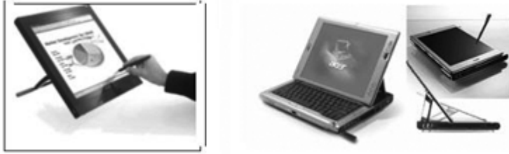
Ilustración 8. Dispositivo que aporta un display interactivo de 17'' a un PC o portátil y ejemplos de tablet PC
