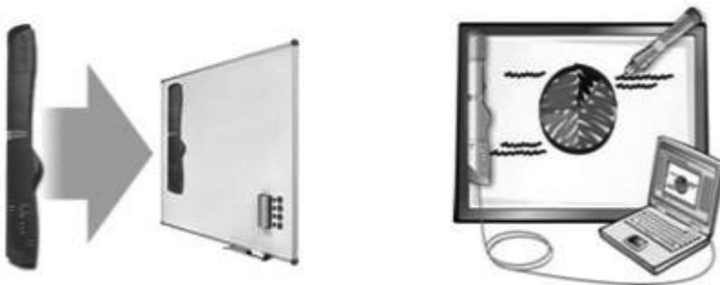
Ilustración 5. Dispositivos que convierten una pizarra convencional en pizarra interactiva.
