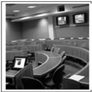
Ilustración 11. Aula de teleenseñanza, permite que el profesor esté ubicado en cualquier sitio remoto dotado de videoconferencia. El sistema de audio de ambiente permite participar a cualquier alumno. Si el profesor es local, puede ver a alumnos remotos en pantallas traseras.
