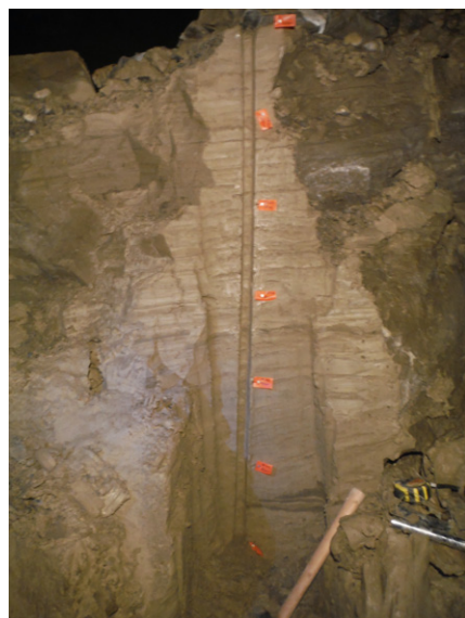
Fig. 2.- Sección de afloramiento con laminación donde se han extraído el u-channel y las muestras cilíndricas discretas. Se ha marcado la sección cada 10 cm (etiquetas naranjas).
