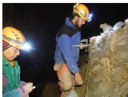
Fig. 3.- Toma de medidas de orientación de las muestras discretas.
