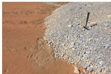
Fig. 2.- Proceso incipiente de drenaje de arena al pie del talud frontal de un lóbulo de tamiz. Ver figura en color en la web.
