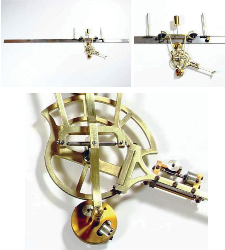
Figuras 3, 4 y 5. Integrador Amsler del ROA. Fuente: Fotografías de la base de datos MILES del Ministerio de Defensa, consultadas en el ROA.
