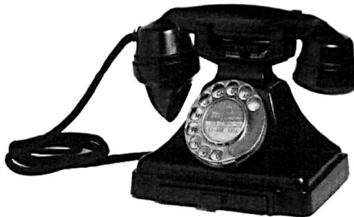
Teléfono automático en baquelita negra con disco giratorio de L.T.R. S.R.C., 1929-1933.
