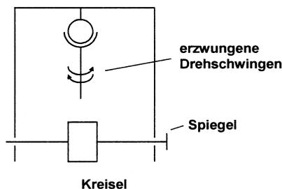
*Man hängt den Kreisel an einem Pfannngelenk auf, wobei man die vertikale Achse der Pfanne um die Vertikale genau symmetrische erzwungene (gegen die Schwingungsdauer) rasche Schwingen [sic] ausführen lässt. Es handelt sich also um dynamische Eliminierung der Lagerreibung. Ich glaube, dass man auf diese Weise die Freiheit von systematischen Störungen besser erzielen kann als bei Verwendung*
