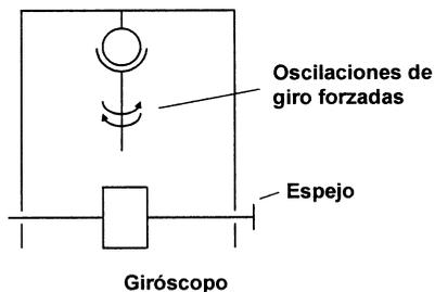
Se suspende el giroscopio de una junta de rótula mientras se hace que el eje vertical de la rótula realice oscilaciones rápidas forzadas (comparadas con el periodo de oscilación) exactamente simétricas alrededor de la vertical. Se trata, por tanto, de la eliminación dinámica de la fuerza de rozamiento. Creo que de esta manera se puede conseguir liberarse de interferencias sistemáticas mejor que utilizando un cable de
