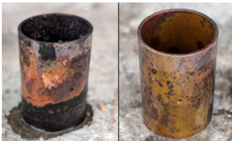
Figura 2. Dos cilindros de cobre calentados con soplete y templados en bilis de toro. En el de la derecha se aprecia claramente el color dorado tras una menor y más indirecta exposición al calor que el primero.
