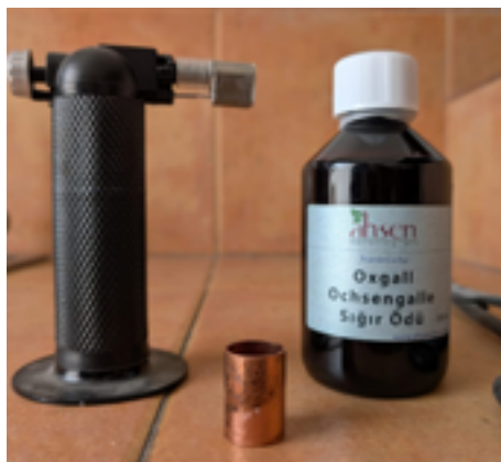
Figura 1. Materiales utilizados para replicar el dorado de cobre con bilis: soplete casero, cilindro de cobre y bilis de toro marca Ahsen Ebru.
