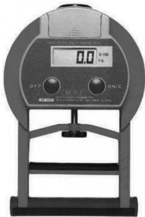
Figura 4. Dinamómetro digital Takei 5401®, para la medición de la fuerza isométrica máxima prensil.
