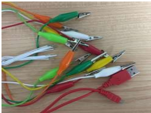
Figura 3. Cableado y pinzas de control
