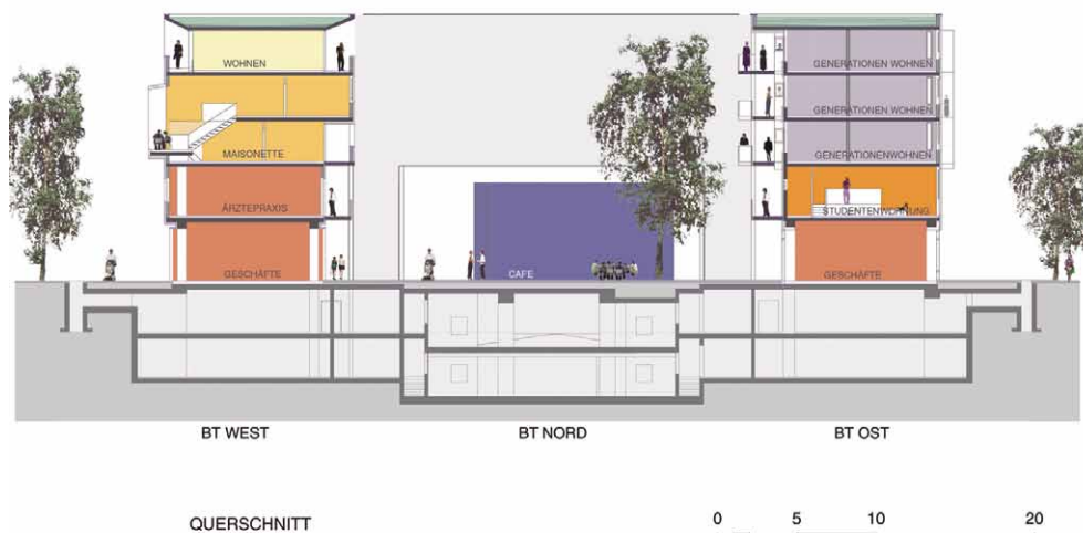
Fig. 17/ Sección transversal, planta 3 a 4 viviendas dúplex familiares en amarillo a la izquierda, planta 2 Minilofts en naranja a la derecha, planta 3 a 5 a la derecha viviendas para mayores, en violeta.
