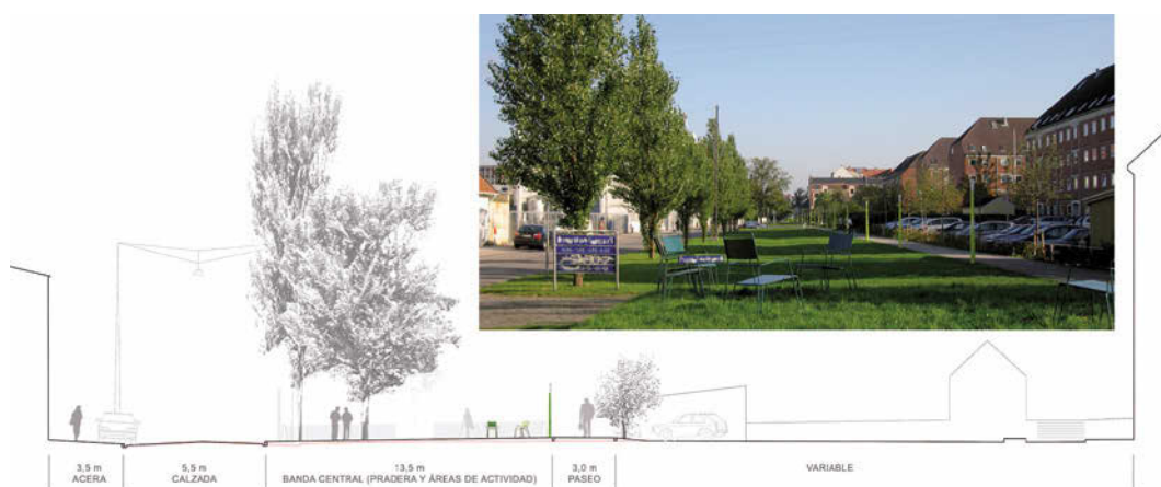
Sección tipo y fotografía del sector central. Redefinición lateral mediante la plantación de álamos, al Norte, y setos y frutales, al Sur. © AKJT y BRA.
