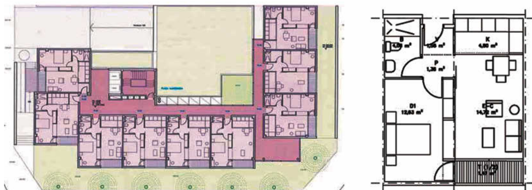
Edificio Sur: Planta tipo. Cada planta dispone de una estancia comunitaria en la esquina Sur-Este. Banda de separación vegetal para garantizar privacidad en planta baja y por control climático. / Módulo de alojamiento: permite la compartimentación y la percepción espacial completa.
