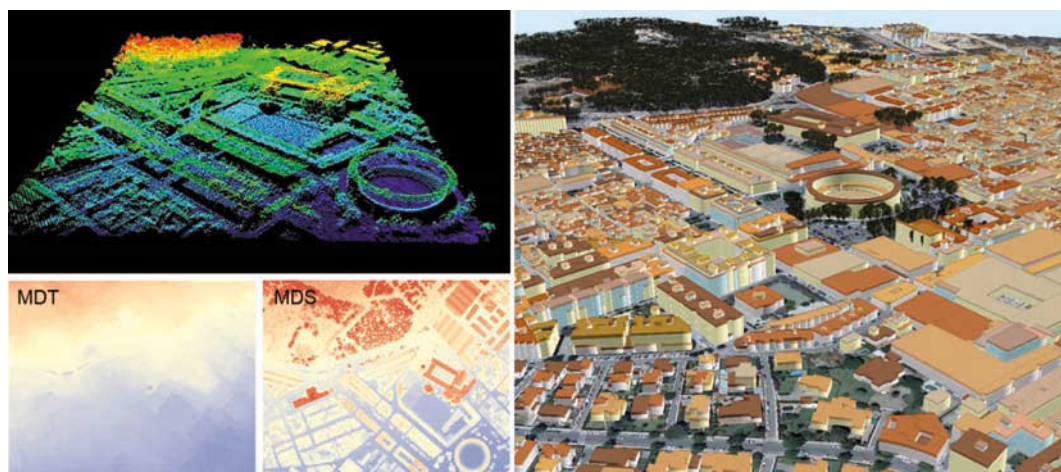
FIG. 6/ Nube de puntos original Lidar, Modelo Digital de Terreno (MDT), Modelo Digital de Superficies (MDS) y reconstrucción virtual en ArcScene de ArcGis para un sector de El Puerto de Santa María
