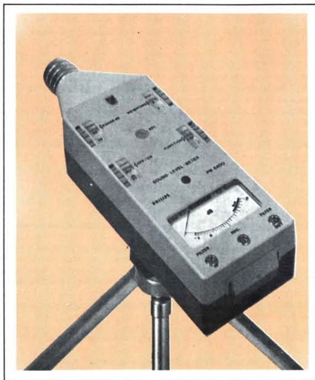
Sonómetro para la medida de ruidos y niveles acústicos, portátil y transistorizado.
