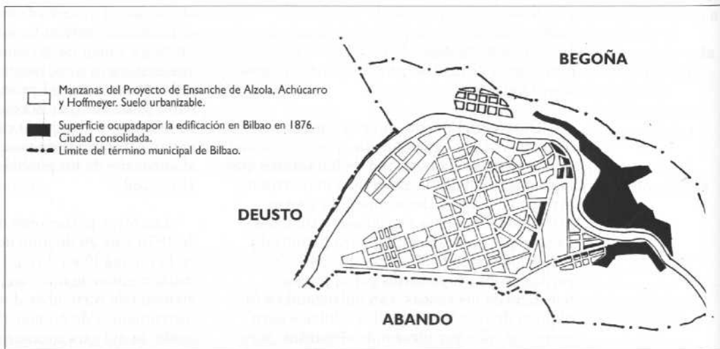
FIGURA 1. 1876. Esquema de la ampliación de la superficie urbanizable de Bilbao mediante el Plan de Ensanche de Alzola, Achúcarro y Hoffmeyer.
