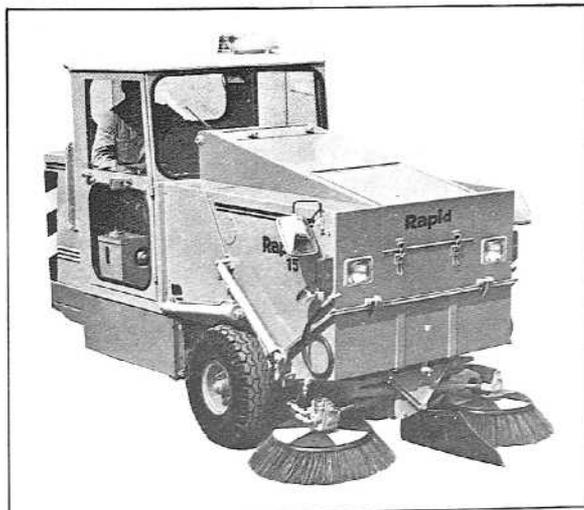
Se presentan en el mercado las unidades Rapid 10 y Rapid 15 que dan con sus 10.000 y 25.000 m<sup>2</sup>/h de barrido, respectivamente, la respuesta a las exigencias de la limpieza viaria que con las ventajas de ser ambas en su funcionamiento por aspiración neumática y de prescindir de filtros proporciona al usuario una gran confianza en rendimiento y economía.
