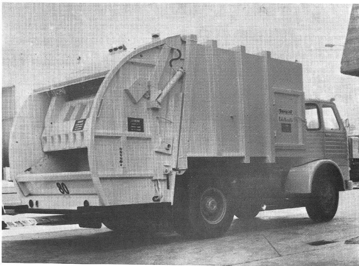
En la actualidad el Recolector de Basuras Colectomatic BBH se fabrica en las capacidades de 12,2, 15,3 y 19 m<sup>3</sup>.
