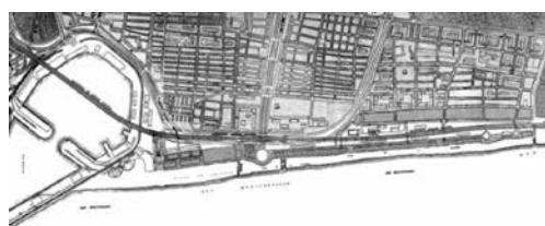
FIG. 12/ Plan Parcial 1975. La ampliación de un metro de anchura se conecta con la Autopista de Barcelona, que atraviesa la dársena interior mediante un paso elevado
