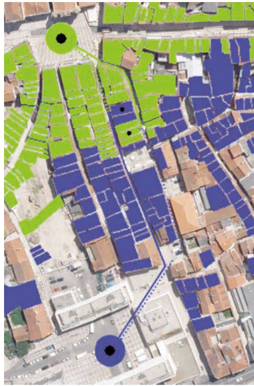
FIG. 9/ Localización óptima de dos zonas refugio, con los edificios asignados (en color) y las rutas primaria (continua) y secundaria (discontinua) de acceso a las mismas en Coimbra
