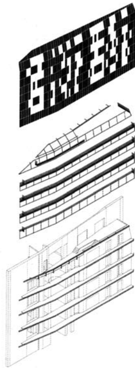
FIG. 12. Ámbitos de actuación. Zonas de expansión - franjas perimetrales permeables: Chartier y Corbasson. Rehabilitación de viviendas en Rue Saint Antoine, París. Una fachada metálica superpuesta define una franja de expansión de uso indefinido
