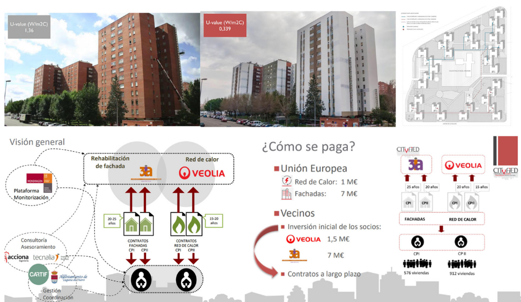
Fig. 16 / Proyecto CITYFIED en Torrelago (Laguna de Duero, Valladolid): Estado anterior y valor de transmitancia de la fachada antes de la intervención (Arriba, derecha) y después (Arriba, centro). Esquema de la red de calefacción de distrito (Arriba, izquierda). Modelo de negocio (Abajo, izquierda) y Esquema de financiación (Abajo, derecha)
