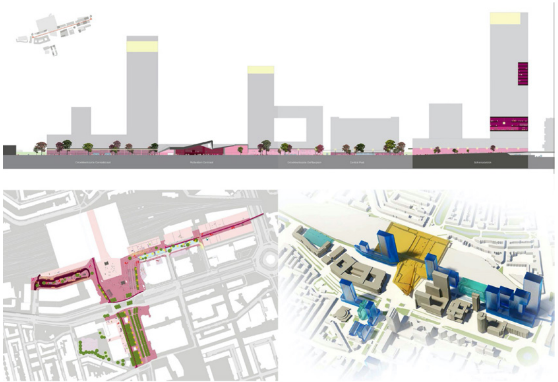
FIG. 6. Sección longitudinal del eje Conradstraat-Delftseplein a través del vestíbulo principal de la estación (superior). Planta de ordenación del espacio público en el entorno de la estación (inferior izquierda) y propuesta de ordenación volumétrica del sector (inferior derecha)
