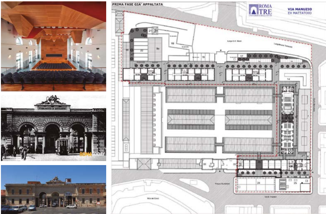
FIG. 8 / Arriba a la izquierda, el interior de un aula realizada dentro de las antiguas naves del Matadero. Abajo a la izquierda foto histórica y contemporánea de la fachada del Matadero. A la derecha, la planimetría del proyecto de rehabilitación
