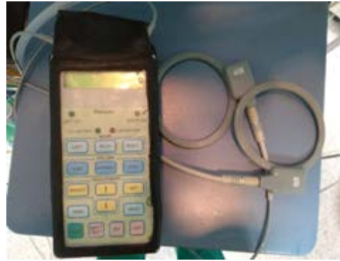
Figura 1. Estimulador de nervio frénico bilateral AtroStim® PNS system V2.0. Se observan los elementos externos al cuerpo: unidad de control con baterías y transmisores de radiofrecuencia.
